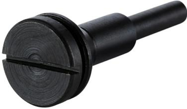
Aufspannbolzen für RHODIUS Minitrenn- und Schrupscheiben. Die höchstzulässige Umfangsgeschwindigkeit bei Verwendung des Bolzens beträgt 50 m/s. Passend für 6 mm oder 10 mm Bohrung, 6 mm Schaft.
