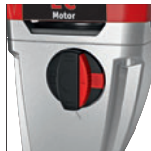
Dispositif d'arrêt de broche breveté Avec protection de démarrage pour un changement sans outil de la tige d'agitateur. Commutateur rotatif pour le réglage de la vitesse de mélange optimale. Niveau d'engrenage 1 : pour les matériaux de construction hautement visqueux, niveau d'engrenage 2 : pour les matériaux de construction moyennement à faiblement visqueux
