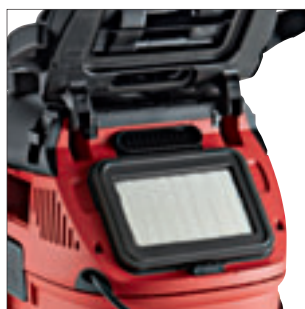
Filtre à plis plats robuste et durable, à revêtement Téflon/nanostructuré Degré de séparation minimal de 99,9 %, lavable. Facilement accessible par le couvercle de maintenance.
