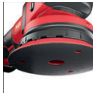
Tête velcro spéciale amortie Ø 150 mm, Ø 125 mm Plateau velcro en PU de 10 mm, très robuste et résistant aux produits chimiques, de dureté moyenne.
