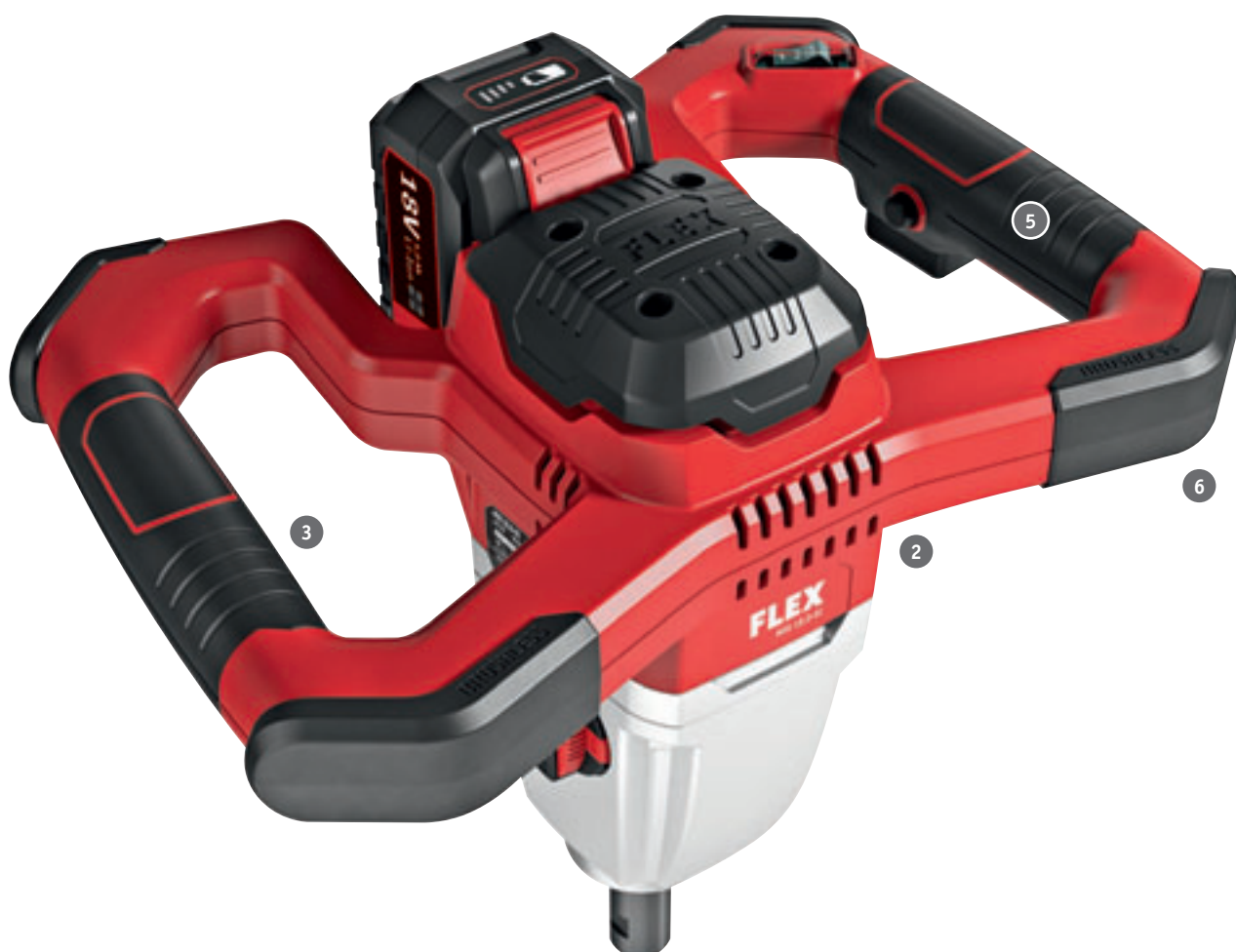
Dispositif d'arrêt de broche breveté Avec protection de démarrage pour un changement sans outil de la tige d'agitateur. Commutateur rotatif pour le réglage de la vitesse de mélange optimale. Niveau d'engrenage 1 : pour les matériaux de construction hautement visqueux, niveau d'engrenage 2 : pour les matériaux de construction moyennement à faiblement visqueux
