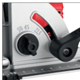
Segment pivotant à double serrage de 0 à 50° Avec fonction de présélection pour les coupes angulaires de 22,5° / 45° / 50° pour un guidage précis et en toute sécurité de la scie lors des coupes angulaires. Empêche le coincement de la lame de scie dans le matériau.
