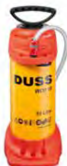
RÉSERVOIR D'EAU SOUS PRESSION Réservoir d'eau sous pression pour un forage indépendant du réseau d'eau, réservoir acier, contenance 10 l, flexible renforcé 2,5 m et 1/2" raccord avec système d'arrêt. RÉFÉRENCE WDB 10
